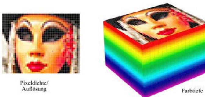
Abbildung 1.5.: Schema einer 8-bit Rastergrafik bestehend aus Pixel und Farbtiefe
