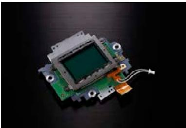
Abb. 1.1.: Der Sensor der Nikon 800 Kamera kann bis zu 14,6 Blendenstufen aufnehmen
